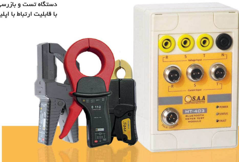
MT-403 دستگاهی پرتابل است که به منظور تست کنتور و اندازه گیری پارامترهای الکتریکی شبکه و نیز محاسبه درصد خطا کنتور تحت تست و انتقال این اطلاعات به اپلیکیشن مرتبط (اندرویدی) از طریق بستر ارتباطی بلوتوث طراحی شده است. این دستگاه متناسب با فرآیند های استاندارد تست و بازرسی لوازم اندازه گیری شرکت های توزیع نیروی برق کشور طراحی شده است و قادر به تست تمامی انواع کنتور های تکفار و سه فاز مکانیکی و دیجیتال می باشد.
