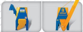
این دستگاه جهت خردکردن علوفه‌های دامی از قبیل یونجه، کاه، چغندر و ... می‌باشد که با نیروی برق کار می‌کند. برای دامداری‌ها و دامپروری‌های صنعتی و نیمه صنعتی بسیار کارآمد می‌باشد.
